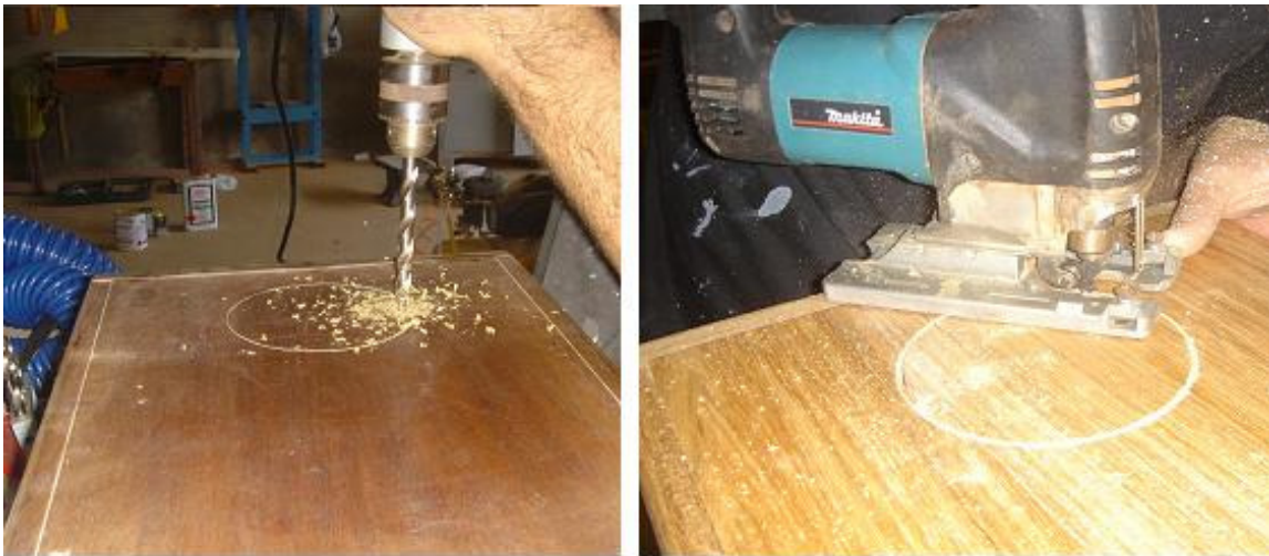
Figura 9. Furadeira e serra tico-tico abrindo furo de 12 cm de diâmetro em peças de ipê e freijó respectivamente.
