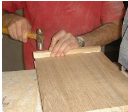
Figura 6. Peça em freijó sendo pregada após colagem.
